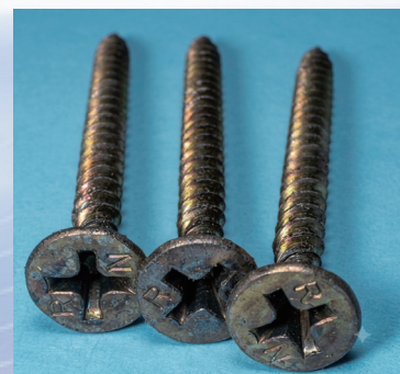
使用離子水除油清洗 退火後 1 4 天沒有生鏽狀況
